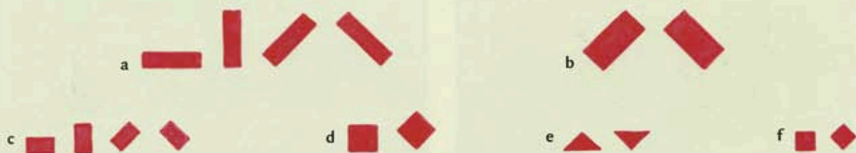
5 De mogelijkheden van vorm, afmeting en stand van bakstenen in siermetselpatronen. Bovenste rij: a. strekken; b. stenen op hun plat. Onderste rij: c. koppen; d. halve stenen op hun plat; e. driehoeken, gehalveerd uit d.; f. klezoren: een derde van een strek.
